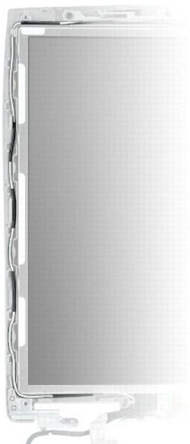
7. ディスプレイパネルから4本のM2 x 3 mm ネジ(片側に2本ずつ)を外します。
