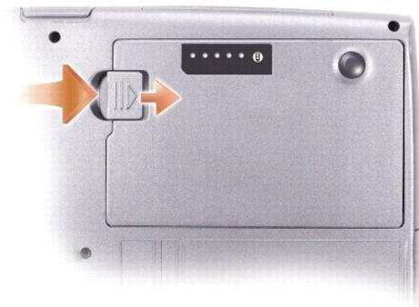
11. メモリモジュール、ミニ PCI カード、セカンドバッテリーが取り付けられている場合はそのバッテリーを含むすべてのデバイスを取り外します。
